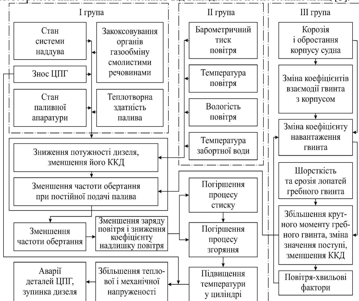
Рис. 2. Вплив експлуатаційних факторів на роботу дизеля
