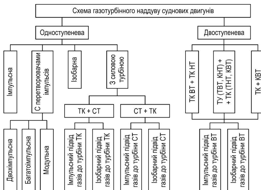
Рис. 1. Ієрархічна схема різних систем газотурбінного наддуву поршневих двигунів:
