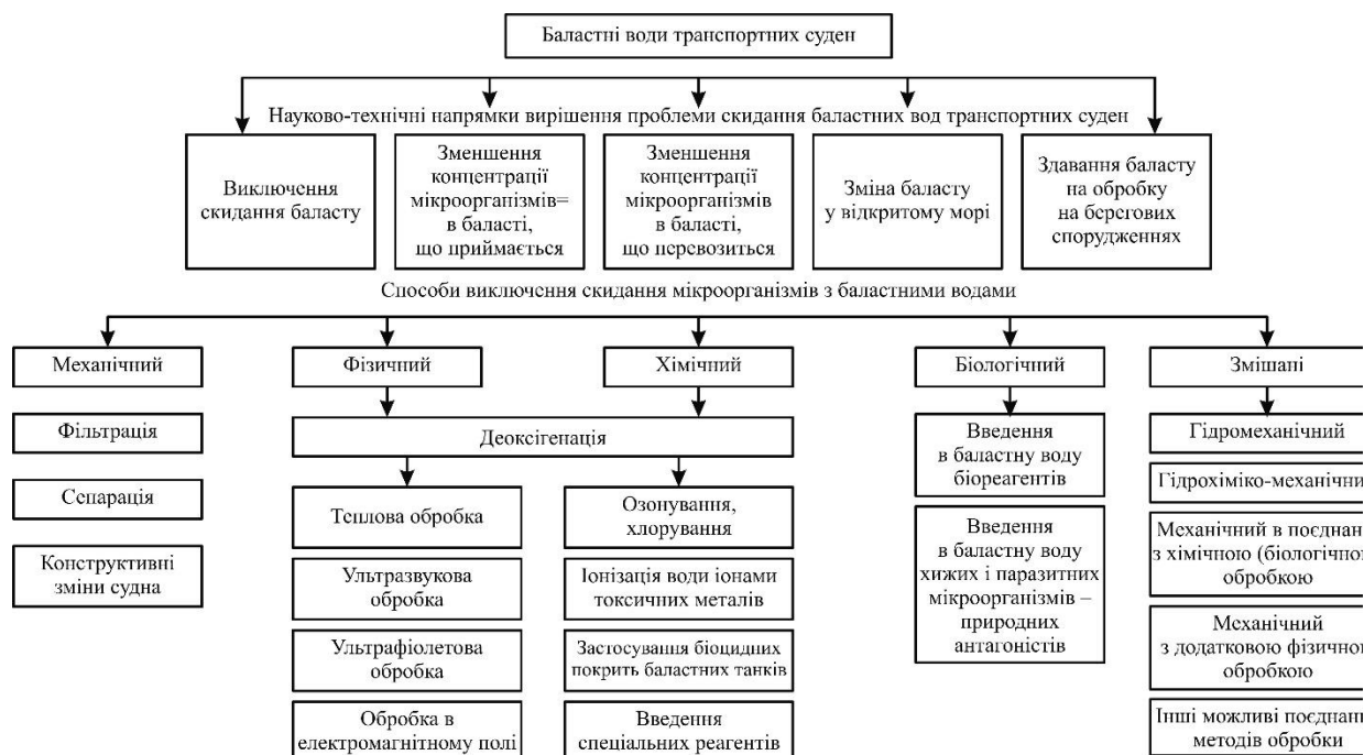
Рис. 6. Можливі методи та способи обробки водяного баласту транспортних суден
